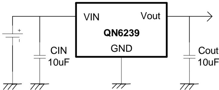
特别注意：当输入电压超过 15V 时，使用陶瓷输入电容上电浪涌电流尖峰严重，必须采用电解电容或者钽电容作为输入电容。
